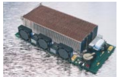
Abb. 4: 50 W Brennstoffzelle mit Regelungsplatte zur autarken Energieversorgung eines Laptops.
