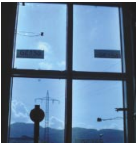
Abb. 1: Durchsicht durch eine gaschrome Verglasung mit Temperatur- und Strahlungssensoren am Fassadenprüfstand.
