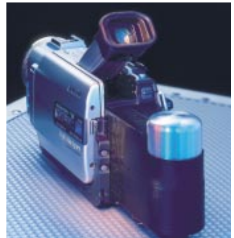
Abb. 3: Komplett integriertes Brennstoffzellen-System für einen handelsüblichen DV-Camcorder. Demonstrations-System der Fraunhofer-Initiative Mikrobrennstoffzelle unter Leitung des Fraunhofer ISE.
