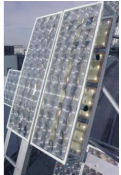
Abb. 4: FLATCON®-Module montiert auf der Nachführeinheit auf dem Dach des Fraunhofer ISE.
