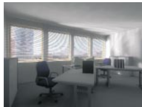
Abb. 4: Beispiel einer Visualisierung unter Verwendung des Photon-Mapping-Algorithmus. Das Bild zeigt die Lichtlenkwirkung verspiegelter Lamellen in einem Büroraum.
