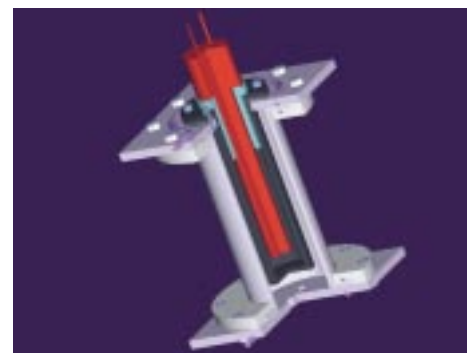
Abb. 4: 50 W Brennstoffzelle mit Regelungsplatte zur autarken Energieversorgung eines Laptops.
