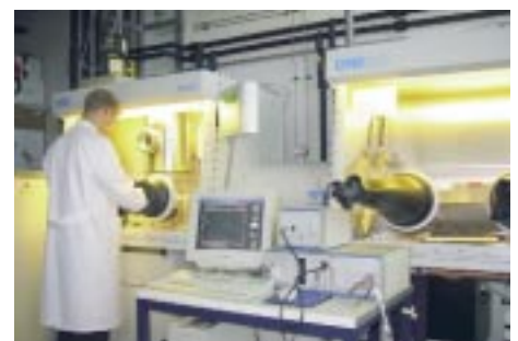
Abb. 3: Herstellung der Organischen Solarzellen in der Glovebox.
