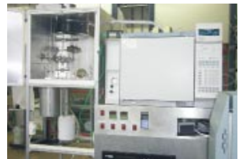
Abb. 4: Teststand zur Charakterisierung von Katalysatoren zur Gasprozesstechnik. Mit dem rechts im Bild sichtbaren Gaschromatographen können wir die Zusammensetzung von Produkt- und Eduktgasen messen.
