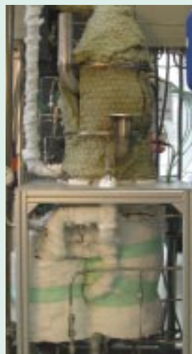
Abb. 2: Gesamtansicht des Erdgasreformers mit angebrachter thermischer Isolation. Der Reformier-Reaktor selbst befindet sich im unteren Teil der Anlage, CO-Shift und Methanisierungsreaktor befinden sich darüber.
