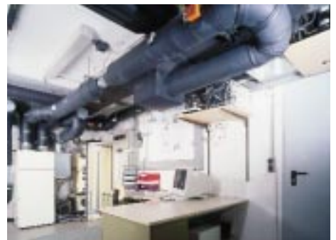
Abb. 3: Automatisierter Teststand mit zwei Testplätzen zur Messung von Lüftungsgeräten mit Abluftwärmepumpe.
