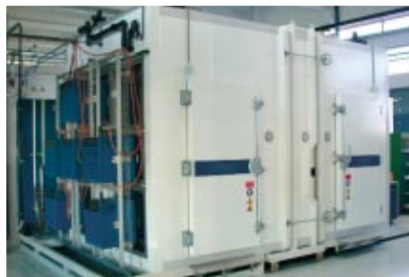
Abb. 2: Doppel-Klimakammer zur Prüfung von Fenstern, solaren Fassaden und Solarmodulen am Fraunhofer ISE. In der Prüfkammer können die Auswirkungen von Klimagradienten in der Gebäudehülle in kontrollierter und überhöhter Weise untersucht werden.
