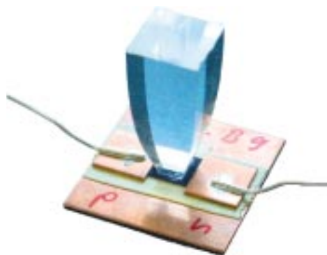
Abb. 1: Zweistufiges photovoltaisches Konzentratorsystem. Trotz einachsiger Nachführung wird eine geometrische Konzentration von über 300 erreicht. Die zweite Konzentratorstufe (CPC) wird direkt auf die speziell hierfür entwickelten Silicium-Konzentratorsolarzellen aufgeklebt (siehe unteres Bild). Die nur 4,5 x 4,5 mm 2 großen Zellen weisen einen Wirkungsgrad von 24% bei hundert Sonnen auf.
