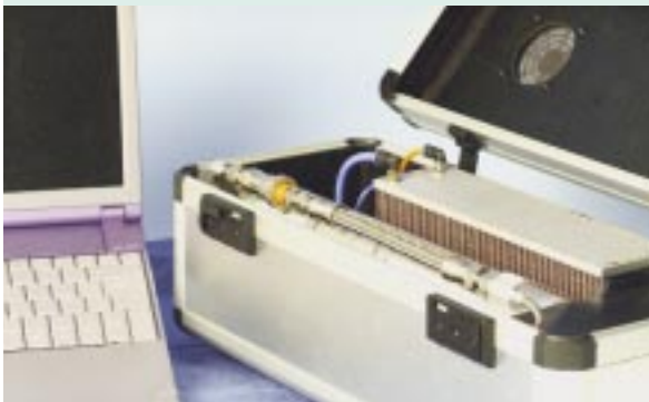
Abb. 1: Brennstoffzellenversorgung für portable elektronische Geräte. Im Vordergrund des Behälters (rechts im Bild) der Metallhydridspeicher mit 250 NI Wasserstoff, dahinter der Brennstoffzellen-Stack mit über 100 W Spitzenleistung.
