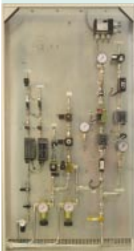
Abb. 1: Teilansicht des neu entwickelten Erdgasreformers. Zu sehen ist die Dosierung der Edukte sowie die Brennergasversorgung. Oben rechts: Feuerungsautomat, Mitte: Regelung der Eduktströme, unten: Zufuhr der Edukte.
