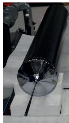
Czochralski-Anlagen für die Monoingotherstellung (links) und Silizium-Einkristalle (rechts).
