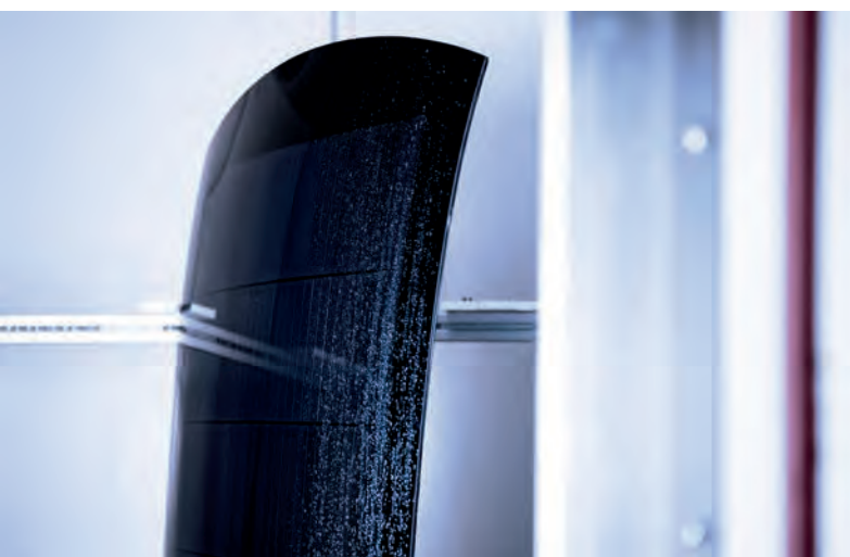
Prüfung eines VIPV-Moduls.
