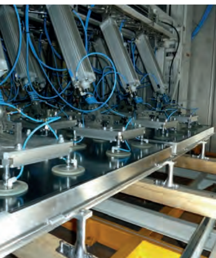
Schublastprüfung eines Gesamtsystems am Belastungsprüfstand aus zwei Kollektoren mit Montagesystem inklusive Tragwerksanbindung bis zum Dachsparren.
