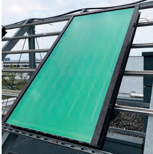
Farbiger, solarthermischer Kollektor bei der Bewitterung auf dem Outdoor-Teststand des Fraunhofer ISE.
