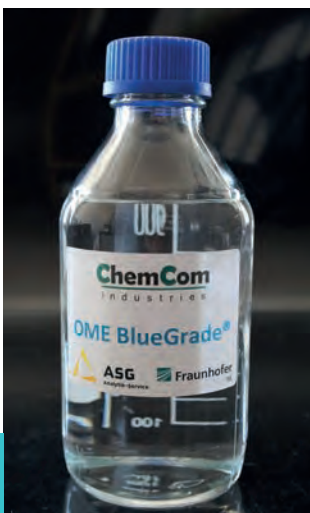
Hochreines OME BlueGrade® gemäß der Vornorm DIN/ITS 51699.
