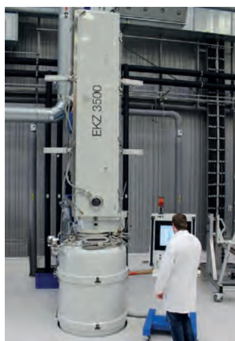
Czochralski-Anlagen für die Monoingotherstellung (links) und Silizium-Einkristalle (rechts).
