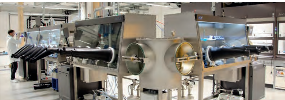
Prozesskette zur Herstellung von Batteriezellen mit Festkörper-Elektrolyt vom Pulver zur Zelle innerhalb einer Glovebox-Linie.
